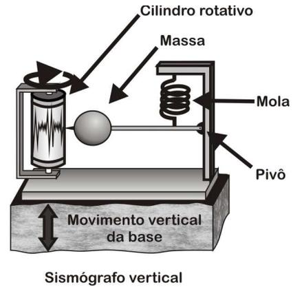
A massa que está na ponta da haste tem 100 g e o comprimento da haste, da ponta até o pivô de articulação, é de 20 cm. Durante um tremor, a haste se move para baixo e isso causa um deslocamento de  $\frac{\pi}{6}$  rad entre a sua posição de equilíbrio e a nova posição. Considerando que  $\text{sen}\left(\frac{\pi}{6}\right) = \frac{1}{2}$ , assinale a alternativa que apresenta, corretamente, a energia despendida no processo.
