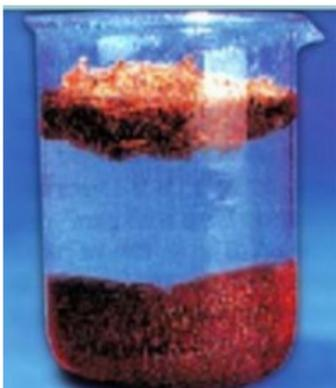
**Dissolução fracionada:** separar utilizando-se de um líquido que tenha propriedade de dissolução de um determinado sólido, em seguida usa-se da filtração ou destilação. Ex: sal da areia.
